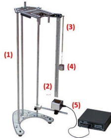
Figura 1: Conjunto do experimento 1 (MHS) - Elementos contidos no conjunto: (1) Conjunto de suporte com tripé, haste e anteparo; (2) Régua metálica 0 a 500 mm; (3) Mola; (4) Massa cilíndrica acoplável; (5) Sensor de posição ultrassônico. (Fonte: estúdios Cidepe Digital)
